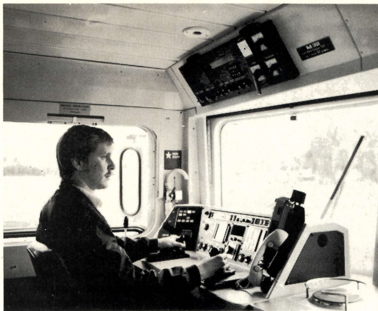
Förarplatsen i en Rc 5. Ovanför vindrutan sitter panelen för felindikeringsarna.
